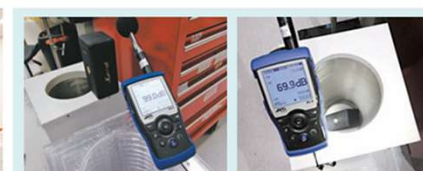
◆降噪測試中，在喇叭播放模擬大型風機的噪音達99分貝(左圖)，把喇叭放進吸音超材料後(右圖)，分貝儀顯示噪音減少約30分貝。香港文匯報記者黃文力攝
